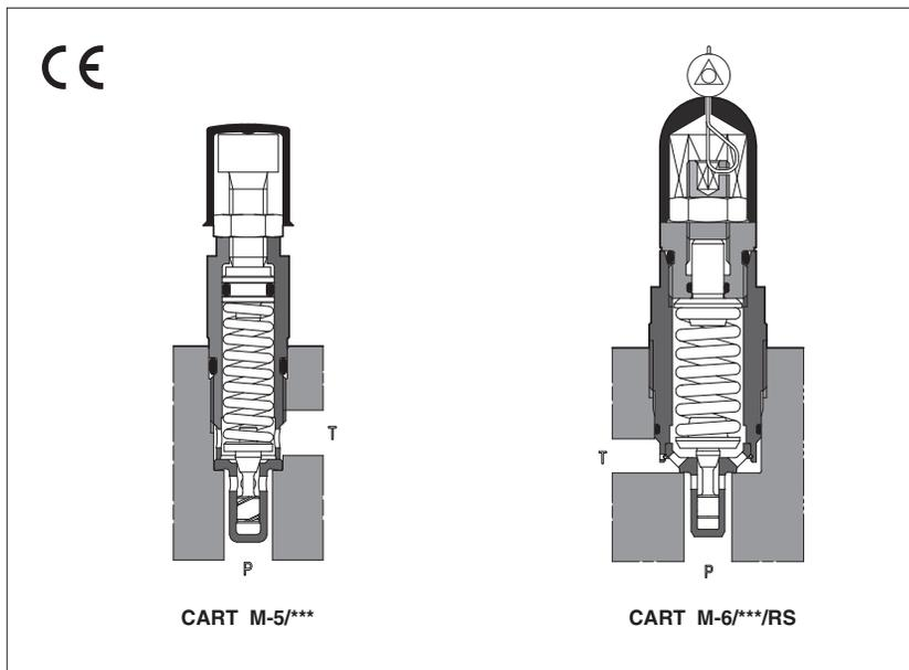
**CART**为螺纹安装直动式溢流阀。它们被用于在液压系统中限制最大压力或用来防护系统元件免受超压破坏。溢流阀有六种尺寸规格，可以满足不同的流量和压力要求。插芯为特殊设计，可以减小阀块和阀组的尺寸，但不影响功能参数。
